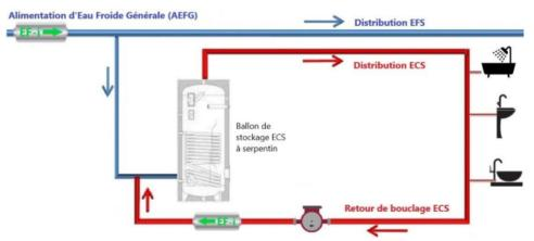
Sur un circuit de Charge : ballon de stockage ECS réchauffé via un échangeur à plaques sur lequel un circulateur assure la circulation donc même problématique que le BECS :
