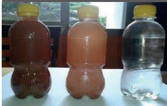
Évolution de l'eau de batterie de 0 à 2 mois.
